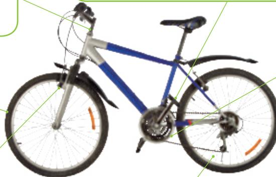
El movimiento de los pedales se transmite a la corona, una **rueda dentada** que hace que se mueva la cadena. Esta, a su vez, mueve los piñones, unas ruedas dentadas unidas a la rueda trasera. El conjunto de corona, cadena y piñones forma la **transmisión**.
