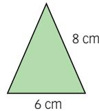
**PRIMERO.** Se aplica el teorema de Pitágoras al triángulo rectángulo de catetos la altura y la mitad de la base, e hipotenusa el lado del triángulo.
