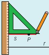
Apoyamos uno de los bordes perpendiculares de la escuadra sobre la recta  $r$ . Después, colocamos la regla pegada al otro borde. Deslizamos la escuadra sobre la regla, hasta que el borde coincida con el punto  $P$ .
