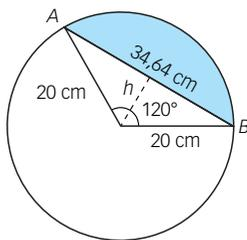
**PRIMERO.** Se halla la altura del triángulo, para ello se aplica el teorema de Pitágoras al triángulo rectángulo cuya hipotenusa es el radio y cuyos catetos son la altura y la mitad de la cuerda  $AB$ .
