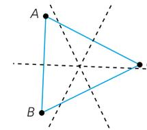
3. Dibujamos una circunferencia con centro en el punto de corte de las mediatrices, y con radio, la distancia a cualquiera de los puntos.
