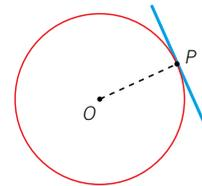
Trazamos una recta perpendicular al radio que pase por  $P$ .
