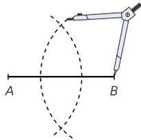
Trazamos dos arcos de igual radio, con centro en  $A$  y  $B$ , que se cortan.
