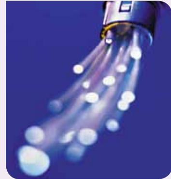
La fibra óptica es el material de las comunicaciones del siglo XXI porque es capaz de transmitir mucha más información que el cable de cobre. Es un hilo del grosor de un cabello, constituido por dos vidrios diferentes de gran pureza, uno contenido en el otro.
