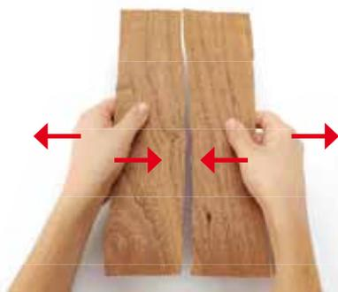
En cambio, en la dirección perpendicular a las fibras es muy débil.
