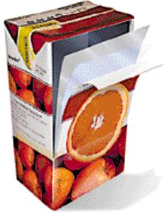
El **tetrabrik** es un material compuesto formado por capas de material plástico, cartón y aluminio. El **plástico** hace que sea impermeable. El **cartón** aporta resistencia. El **aluminio** conserva los alimentos sin dejar pasar la luz.
