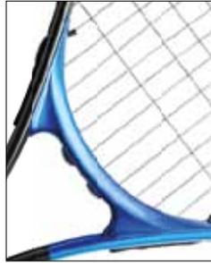
La **fibra de carbono** suele combinarse con otros materiales para formar compuestos. Por ejemplo, se combina con algunos **plásticos** y da lugar a materiales muy resistentes y ligeros que se utilizan para fabricar raquetas, bicicletas...
