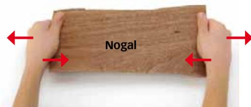
La madera resiste muy bien esfuerzos de **tracción** y **compresión** en la dirección paralela a las fibras.
