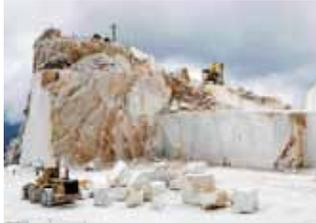
**1. Extracción.** Las rocas se arrancan de la corteza terrestre en la cantera con máquinas o explosiones controladas.
