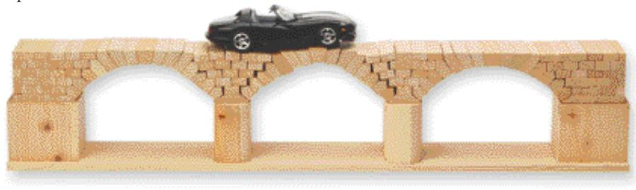
Los arcos romanos se mantienen gracias al apoyo de un ladrillo sobre otro; no se utiliza ningún adhesivo entre las piezas. Estas suelen tener forma de cuña y encajar perfectamente.
