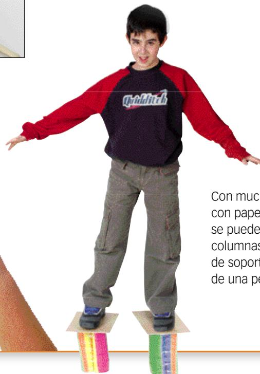
Con muchas pajitas unidas con papel adhesivo se pueden construir columnas capaces de soportar el peso de una persona.
