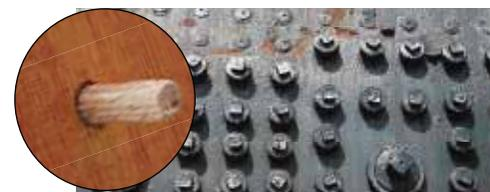
Las **espigas** de un mueble soportan esfuerzos de cortadura o cizalla.
