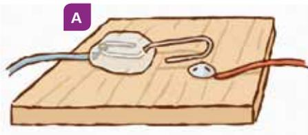
Dobla un clip y pega un extremo a la base con pegamento termofusible. Clava una chincheta, sujeta los cables y... ¡a pulsar!
