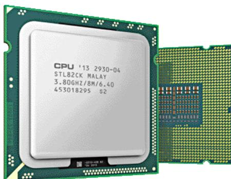
En muchos componentes electrónicos hay minúsculos transistores. En un **microprocesador** moderno, por ejemplo, hay más de 1000 millones de transistores.
