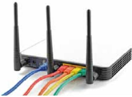
El **router** se conecta al ordenador mediante un cable de red o bien de manera inalámbrica.
