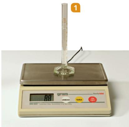
2. Echa agua en la probeta y colócala en la balanza. Anota la masa y el volumen.
