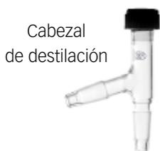
Cabezal de destilación
