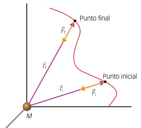
Figura 1.8. El trabajo de la fuerza gravitatoria depende únicamente del punto inicial y final; no de la trayectoria.
