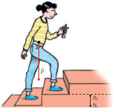
**Figura 1.9.** En cada paso se produce un desplazamiento en horizontal ( $\Delta x$ ) y otro en altura ( $\Delta h$ ). La fuerza peso es perpendicular al desplazamiento horizontal, por eso no realiza trabajo en ello. El trabajo de la fuerza peso depende solo del desplazamiento en altura.
