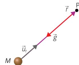
**Figura 1.4.**  $\vec{g}$  y  $\vec{r}$  ( $\vec{u}_r$ ) tienen la misma dirección y sentidos opuestos,  $\vec{r}$  (morado) va de la masa  $M$  al punto  $P$ , mientras que  $\vec{g}$  (rojo) tiene su origen en  $P$ .
