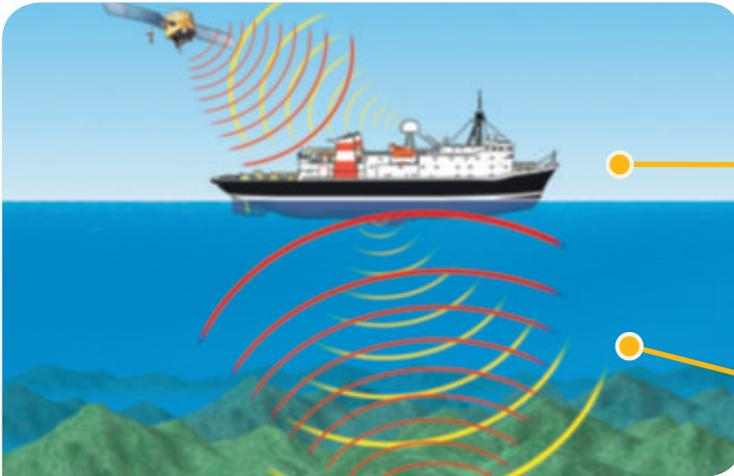
El sonar, instrumento derivado del radar, emite señales acústicas que, tras chocar con un objeto (rocas del fondo, por ejemplo), «rebotan» hasta el aparato emisor.
