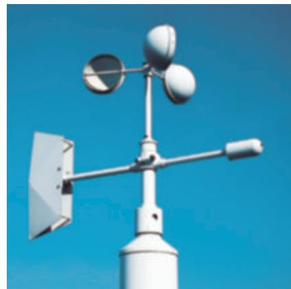
**Figura 0.1.** En un **anemómetro** debe haber unas cazoletas que midan la intensidad del viento y una veleta que determine su dirección.
