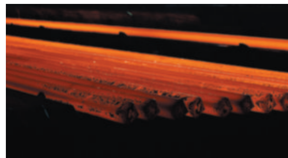
1.7. irudia. Esperimentuetan ikusi denez, gorputz bat berotzen denean, zenbait koloretako argia igortzen du; besteak beste, infragorria tenperatura txikietan, eta zuria, tenperatura altu-altua denean. Argazkian, altzairua ikusten da, oso tenperatura altuan.
