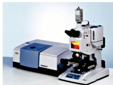
Figura 1.13. Aparato de espectroscopía infrarroja. A la derecha se puede ver el dispositivo para preparar la muestra. El compuesto a analizar se mezcla con un compuesto iónico (NaCl o KCl) y se prensa a una presión elevada en ausencia de humedad.
